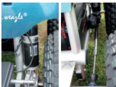
Einer der beiden Antriebsmotoren; Lenkungsmotor
